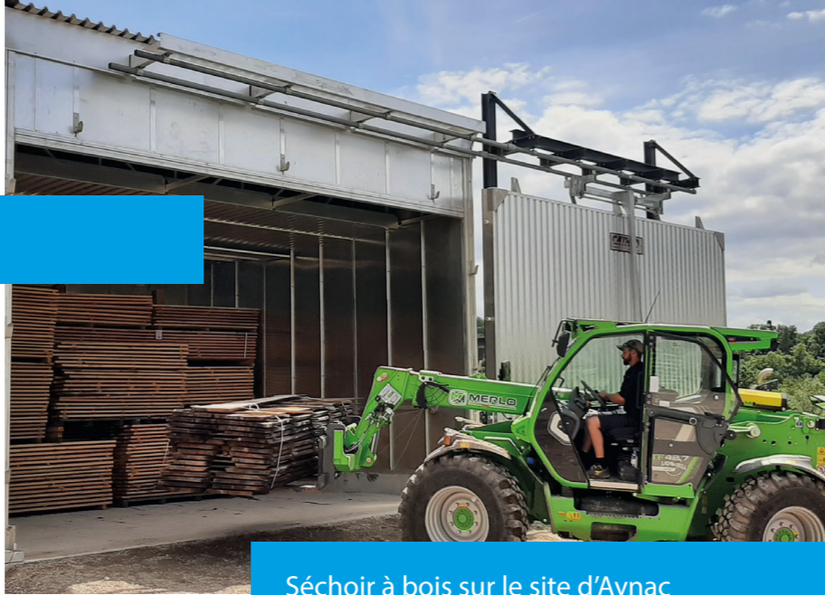
Séchoir à bois sur le site d'Aynac
